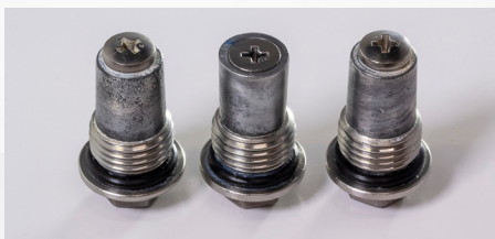
Ânodos internos após a limpeza
